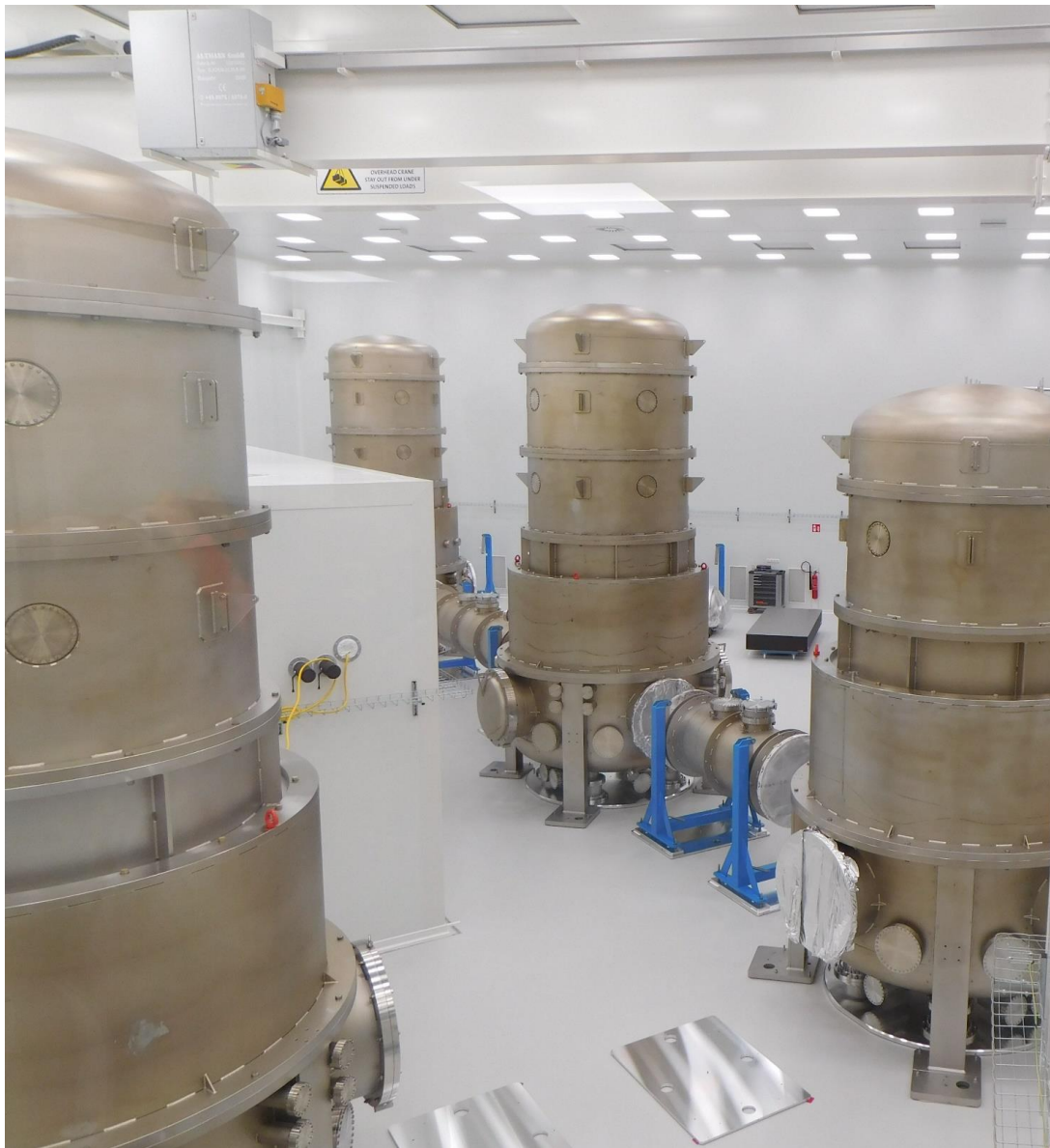
Enkele van de vacuümtorens waarin de onderdelen van de ET worden getest. Foto: Wylliam Robinson
